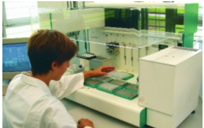
Abbildung 3: Verwendung eines Pipettierroboters für die Probenvorbereitung eines Sequenzierlaufs.
