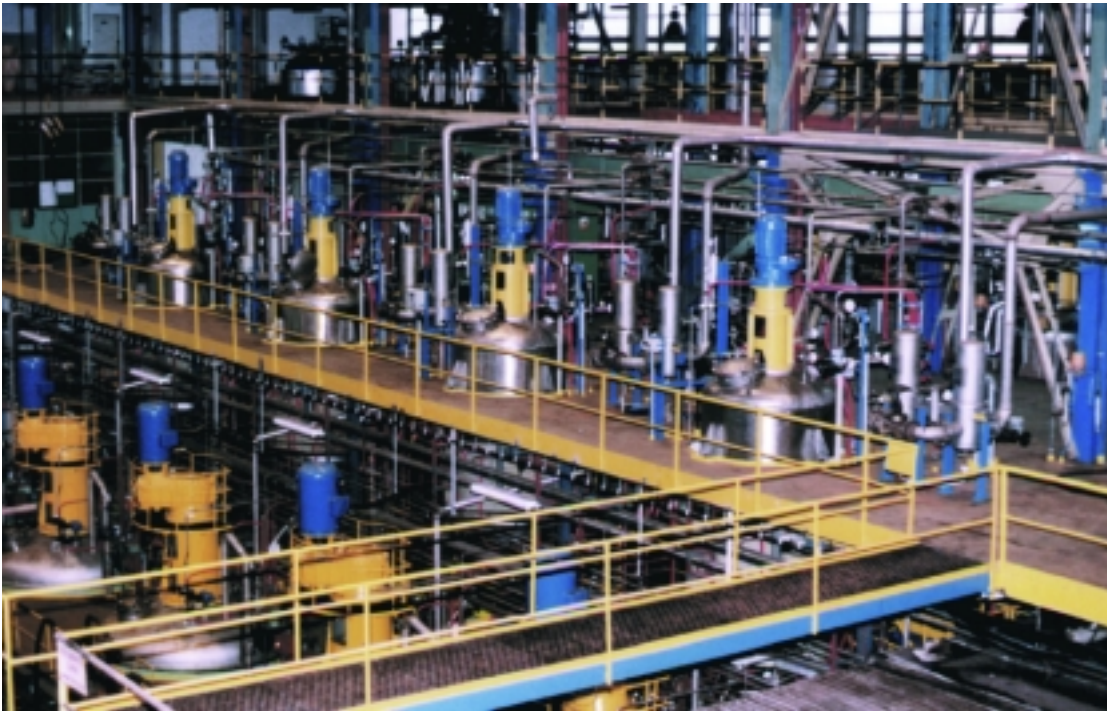
Abbildung 1: Eine industrielle Produktionsanlage für Aminosäuren. Hier produzieren Mikroorganismen in großen Rührkesseln (Fermentern) Aminosäuren im Tonnen-Maßstab. Gezeigt ist eine Reihe von Vor- (obere Reihe) und Hauptkultur-Fermentern (untere Reihe) und das komplexe Netzwerk von Zuleitungsrohren, über die die Mikroorganismen mit Nährstoffen versorgt werden.
