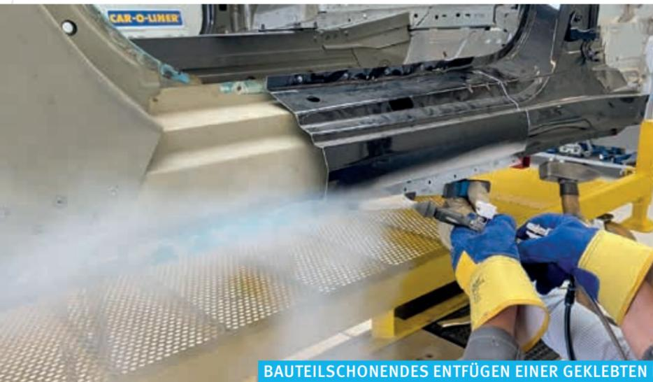
**BAUTEILSCHONENDES ENTFÜGEN EINER GEKLEBTEN KAROSSERIEAUSSENHAUT DURCH DEN EINSATZ DES ENTWICKELTEN VERFAHRENS.**
