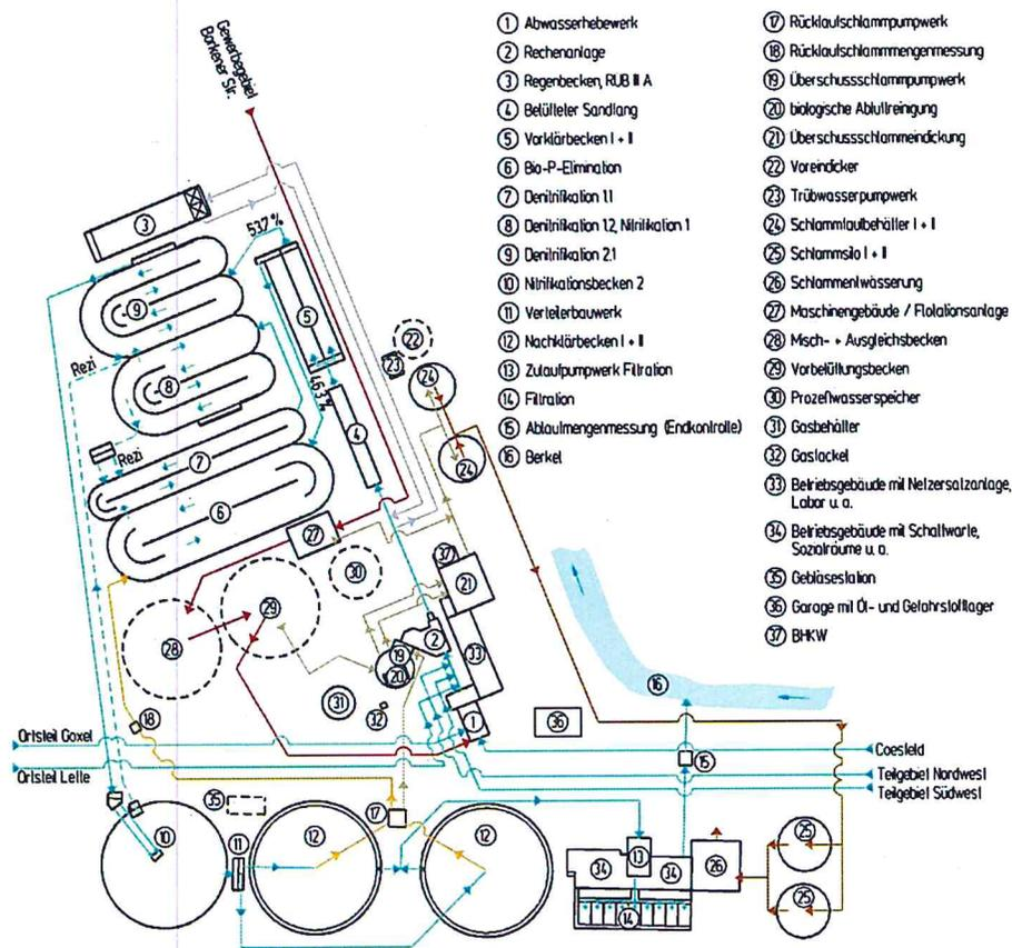
Der Abwasserreinigungsprozess des Zentralklärwertes in Goxel ist im Fließbild schematisch dargestellt.
