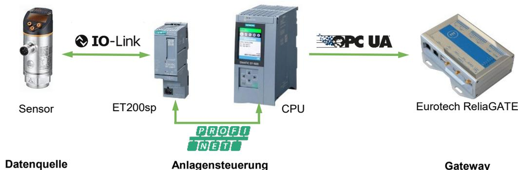
Bild 6-6: Schematische Darstellung der Datenübertragungsstecke auf Feldebene inkl. der jeweiligen Übertragungsprotokolle
