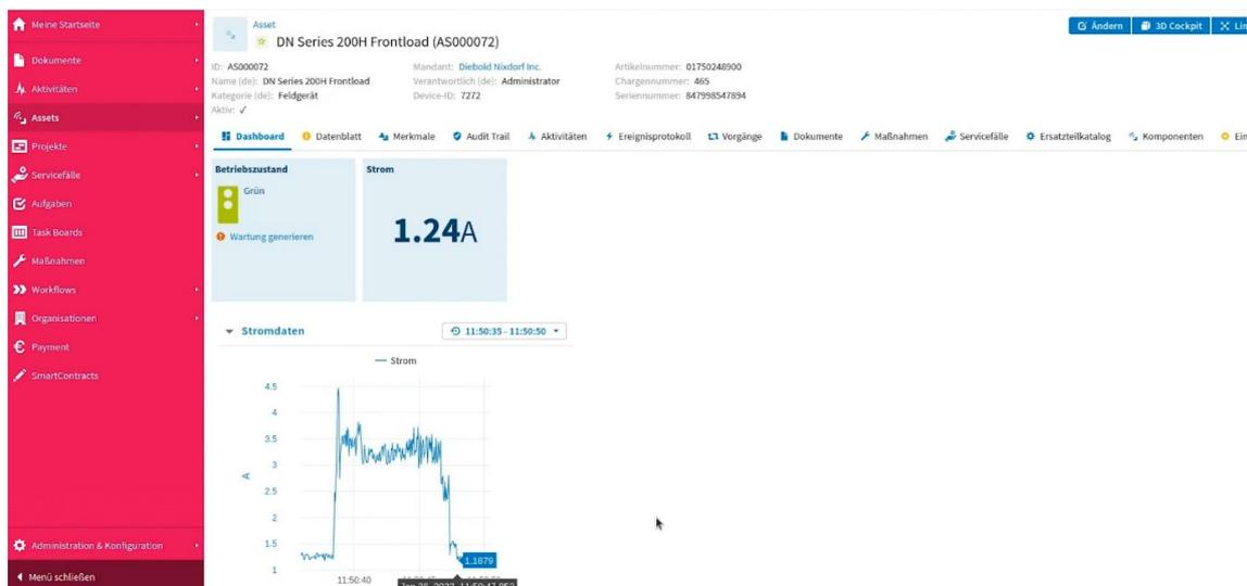
Bild 6-19: Digitaler Zwilling des Geldautomaten in CONTACT Elements for IoT
