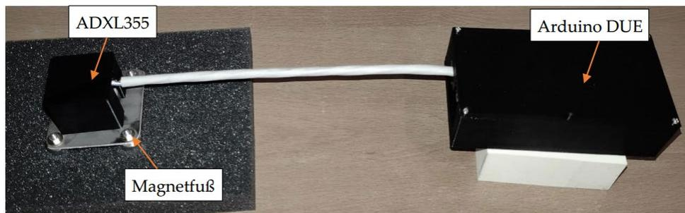
Bild 6-30: Messsystem Arduino DUE + ADXL355
