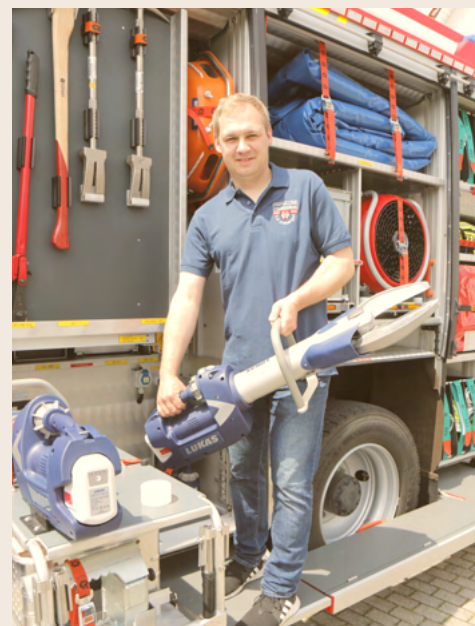
Löschgruppenführer Pascal Klein mit der akkubetriebenen Rettungsschere
