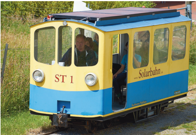
Die grüne „Diema“ aus der „Diepholzer Maschinenfabrik Fritz Schüttler“ fühlt sich pudelwohl bei den Feldbahnfreunden Lippe. Hans-Ulrich Ottensmeyer steuerte die von ihm konstruierte Solar-Eisenbahn ELSE. Solarzellen auf dem Dach des Triebwagens sorgen für die Fahrenergie. Fotos: Archiv Postillon
