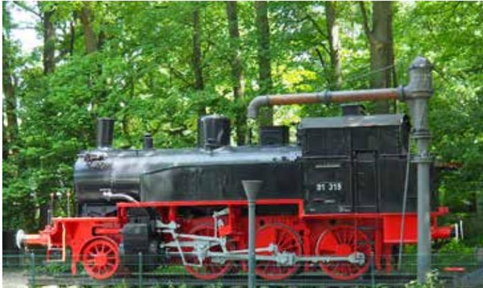
Die historische Dampflok der Baureihe T 9/3 von 1902 mit Wasser-Betankungsanlage. Die Lok steht stilleht an den heute noch genutzten Gleisen der WLE.
