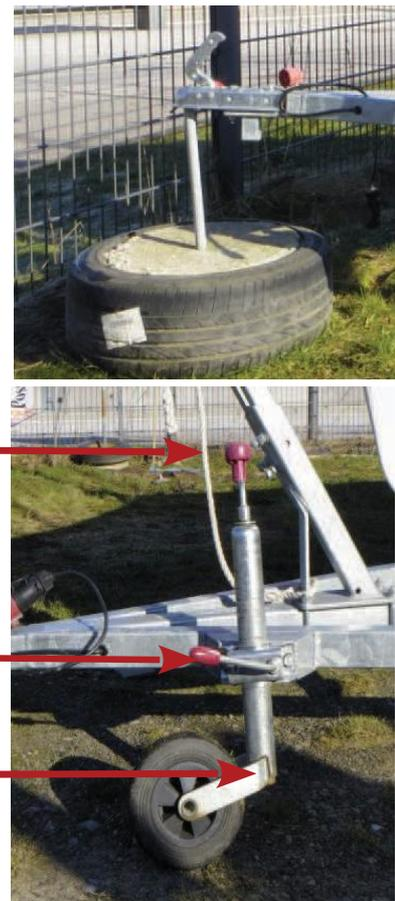
Der Trailer mit Boot kann bei Bedarf vom Abstellplatz auf eine freie Fläche, z.B. vor den Container oder die Sliprampe, manövriert werden, so dass das Boot gut zugänglich ist. Beim Slippen kann das Vorderrad arretiert werden, damit es nicht ausschlägt.
