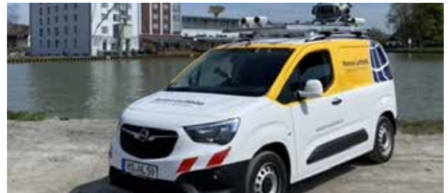
Messfahrzeug für die Bild- und Laserscanaufnahme des Straßenraumes, [Quelle: Hansa Luftbild AG]
