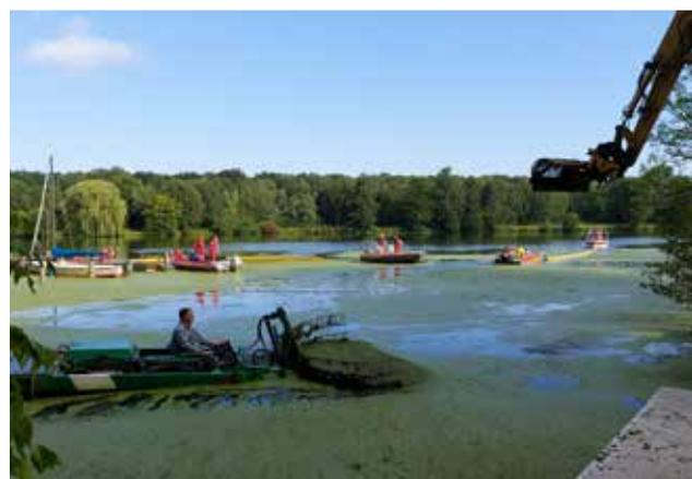
Eine wesentliche Erkenntnis ist, dass die Produktivität des Zusammenschiebens der Wasserlinsen im Wesentlichen von der Windstärke und -richtung abhängig ist und dass der Einsatz von Ölsperren zum Zusammenschieben von Wasserlinsen sich im Vergleich zum eingesetzten Mähboot weniger gut eignen.
