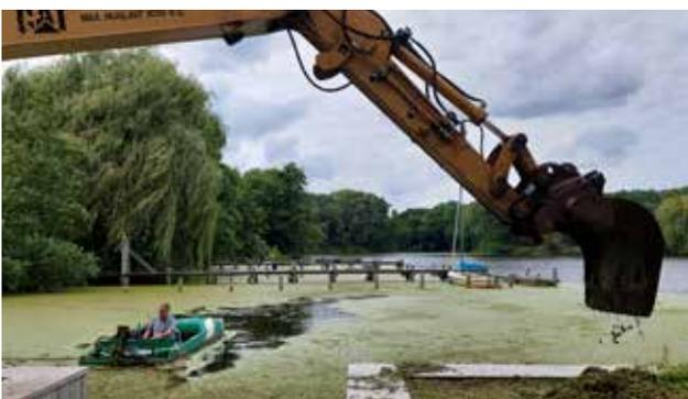
Mit Hilfe des Mähbootes werden die Wasserlinsen zusammengeschoben und zum Ufer gebracht. Ein Bagger mit präparierter Schaufel schöpft die Wasserlinsen ab und verbringt sie in eine vom Bauhof zur Verfügung gestellte Mulde.
