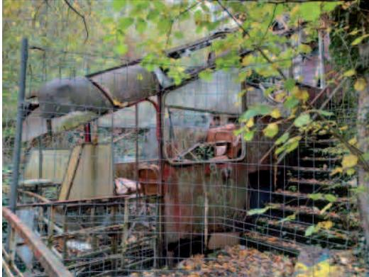
Der Betrieb der 1887 erbauten Zahnradbahn wurde aus wirtschaftlichen Gründen 1979 eingestellt. Eine Standseilbahn mit Wasserübergewichtsantrieb (Wasserballastbahn) kam hier zum Zuge. Während der eine Wagen an der Talstation aufwändig saniert wurde, verrottet der andere an der Bergstation. Unsere Wanderung führte anfangs in Serpentinaugenblicken recht steil den Berg hinauf, später dann gemächlich weiter zur Bergstation. Der hier fixierte Wagen ist
