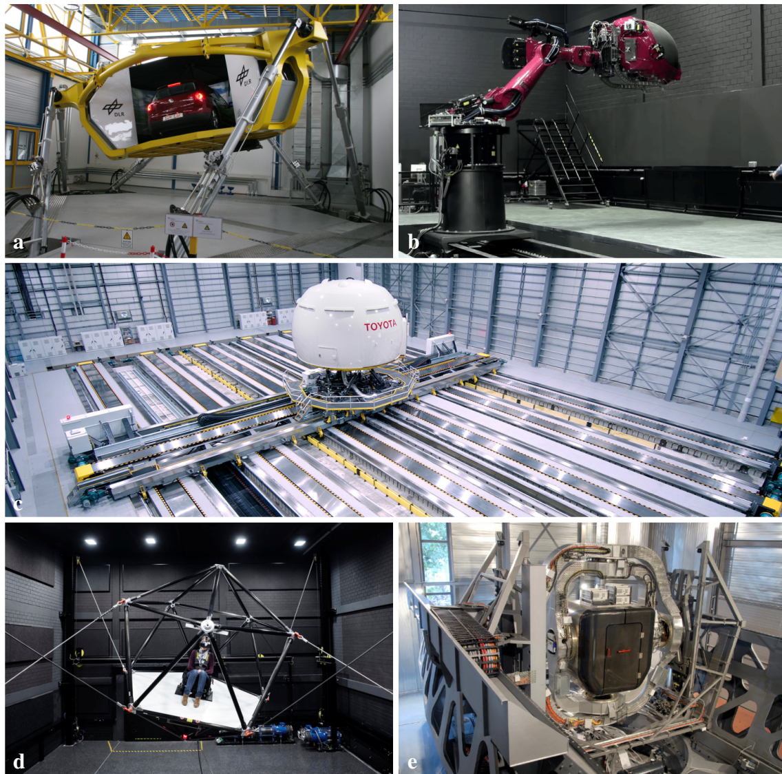
Bild 2-2: Beispiele dynamischer Fahrsimulatoren: a SimCar [Fis09], b CyberMotion [NB13], c Toyota Fahrsimulator [MYAN09], d CableRobot [MLB + 16], e Desdemona Simulator [FWRB07].
