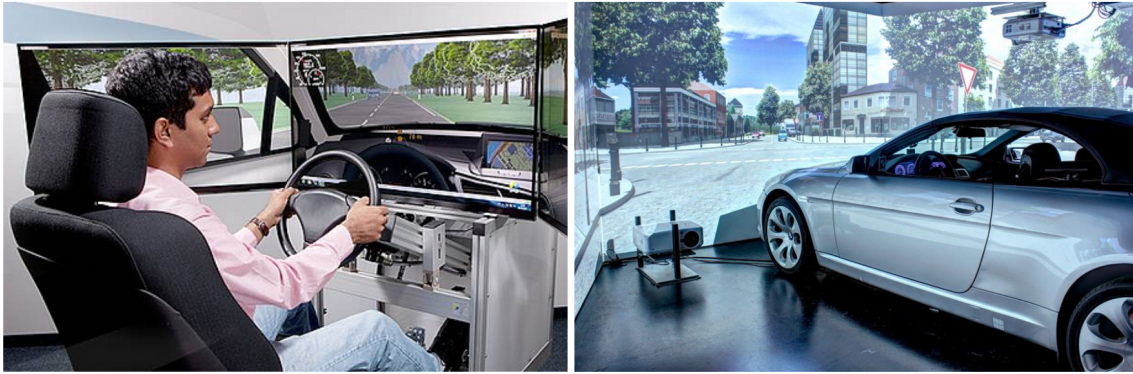
Bild 2-1: Beispiele statischer Fahrsimulatoren mit unterschiedlichen Komplexitätsgraden [IPG20; LFE20].
