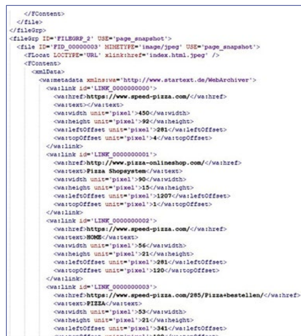
Abb. 5: Abbildung der Seitenstruktur mit Pixelkoordinaten in XML
