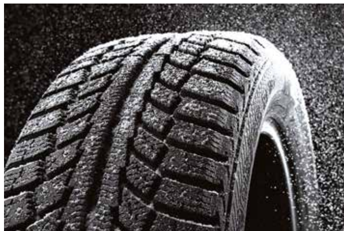
Auch das Profil des Winterreifens erhöht die Sicherheit. Die hohe Anzahl an Lamellen in den einzelnen Blöcken greift besser in Schnee und Eis. Foto: IngImage.com
