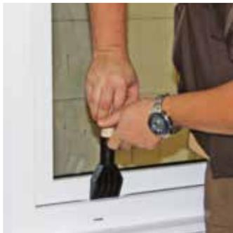
Einbruchversuch normales Fenster, geöffnet innerhalb von Sekunden
