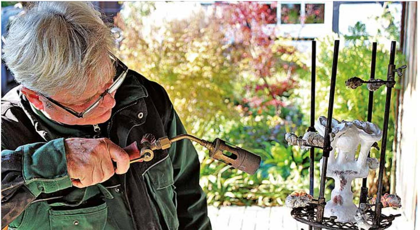
Wachsausschmelzverfahren – 24 Buchstaben Technik. Damit entstehen die Werke von Hartmut Lübbert. Das Wachsausschmelzverfahren findet Anwendung bei formtechnisch schwierigen Skulpturen oder bei besonders hohen Anforderungen an Oberflächengenauigkeit und -schräfe. Die Modelle werden meist aus Wachs hergestellt. Im Verlauf des Verfahrens wird sowohl das Modell als auch die Form zerstört. Daher wird es auch als Verfahren mit verlorenem Modell bezeichnet. Foto: Pielorz
