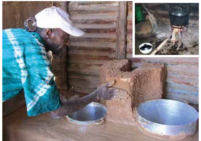
Schon oft ist das Ehepaar Fröber in Gambia gewesen. Dieses Foto zeigt den Herdbau, der bereits begonnen hat. Das kleine Foto zeigt die bisherige traditionelle Kochweise aus drei Steinen mit einem sehr hohen Holzverbrauch. Aus Lehm entstehen nun Kochherde, die sowohl ökonomisch als auch ökologisch und gesundheitlich viel bewirken können. Gemeinsam mit den Dorfautoritäten soll dieses Projekt verbessert werden. Dafür wird auch der Lehm auf seine Eigenschaften hin untersucht. Fotos: privat
