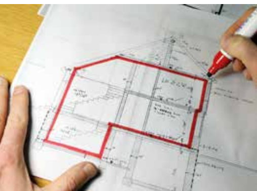
txn-p. Alles dicht? Die Gebäudehülle will lückenlos geplant sein. Foto: FLiB e. V./txn-p
