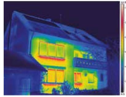
txn-p. Bei kalten Außentemperaturen kann eine Wärmebildaufnahme des Eigenheims gemacht werden. So sind energetische Schwachstellen im Wärmeschutz leicht zu erkennen. Foto: RWE/txn
