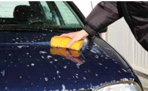
**2.** Nach der Außenreinigung empfiehlt sich eine Kontrolle von Lack und Kunststoffen. Auf Flugrost achten und mit säurefreiem Flugrostentferner beseitigen. Lackpolituren entfernen feine Kratzer besonders effizient mit maschineller Unterstützung. Wenn Kratzer bis auf die
