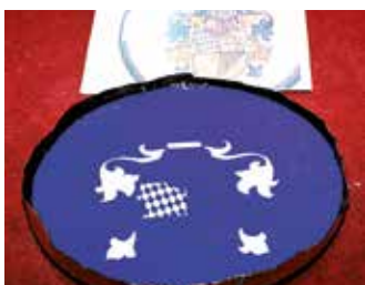
So entsteht das Wappen in den Händen von Kunstglaser Günter Pohl: Gearbeitet wird mit einem Überfang-Glas. Das ist ein zweischichtiges Glas, weiß mit einem Drittel Millimeter Blau (Foto ganz links). Die blaue Farbe wird mit Fluss-Säure abgeätzt - mit Ausnahme der zuvor abgeklebten Stellen. Der Vorgang dauert mehrere Stunden. Das Ergebnis inklusive der ersten Konturmalerei ist auf dem zweiten Foto zu sehen. Die Farben werden bei 650 Grad in einem Ofen gebrannt (drittes Foto). Zunächst entstehen die Konturen, danach wird das vollständige Wappen gemalt und in eine Bleifassung eingelassen (viertes Foto). Es zierte später eine Wohnzimmertür.
