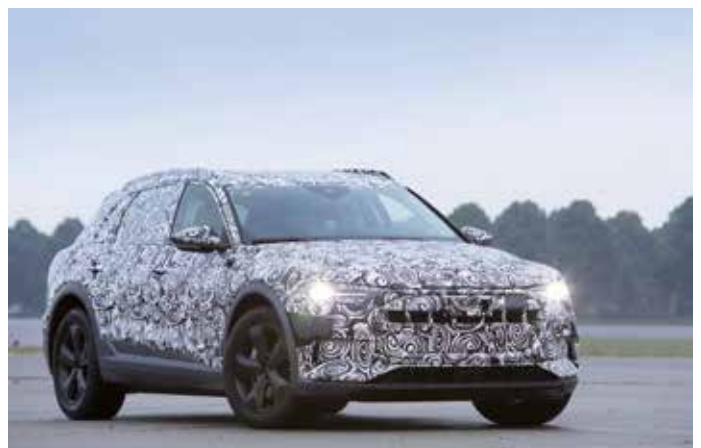
Der „e-tron quattro“ kommt 2018 auf den Markt, zunächst in einer Variante mit rund 385 PS mit drei Elektromotoren, von denen zwei an der Hinterachse sitzen. Später wird eine schwächere Variante mit jeweils einem Front- und Heckmotor nachgereicht. Foto: Auto-Medienportal.Net
