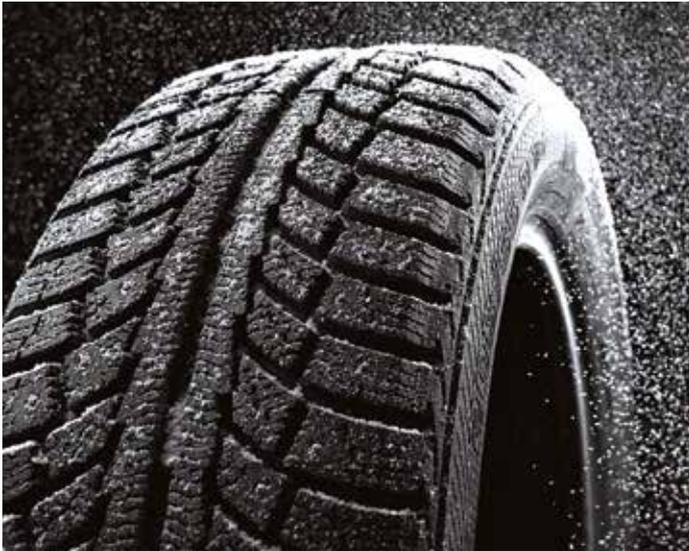
Auch das Profil des Winterreifens erhöht die Sicherheit. Die hohe Anzahl an Lamellen in den einzelnen Blöcken greift besser in Schnee und Eis. Foto: IngImage.com
