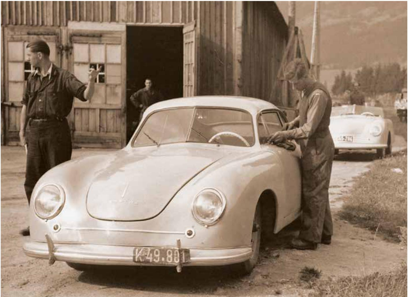
Fahrversuchsleiter Helmut Bott beschreibt den Verlauf der „ersten Probefahrt mit dem Prototypen“. Bott hatte eklatante technische Mängel entdeckt. Er kritisierte, dass der Wagen zu giftig auf Lenkkorrekturen reagiere und das Heck ausbreche, dass die Vorderachse falsch eingestellt sei, dass die Bremse schnell schlappmache und dass das Getriebe heule.
