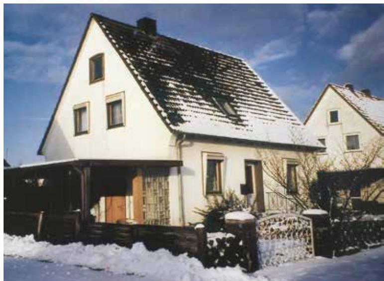
txn-p. Eigenheimbesitzer aufgepasst: Ist das Dach von Schnee bedeckt, lassen sich Schwachstellen in der Wärmedämmung meist gut erkennen. Dort, wo der Schnee schnell schmilzt, geht wertvolle Heizenergie verloren.
