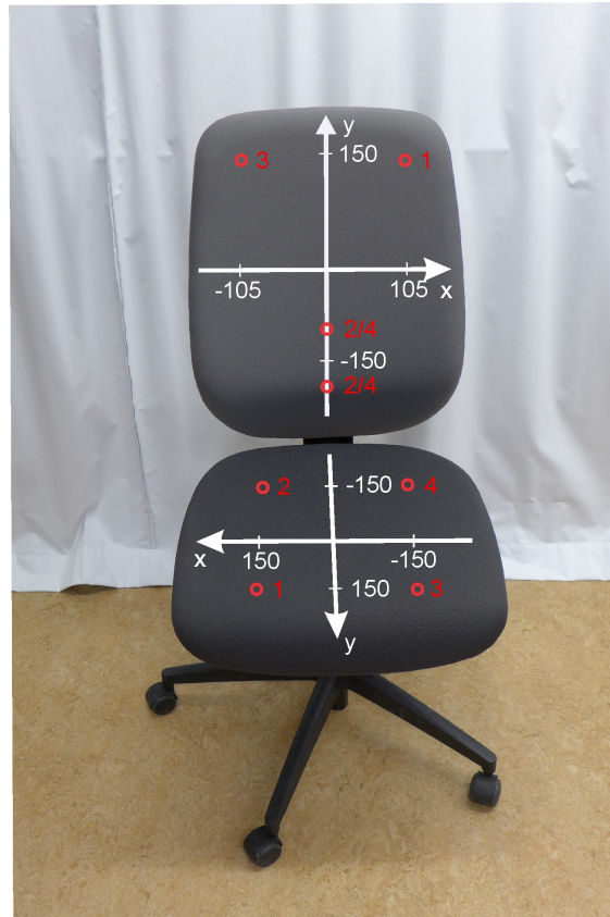
Abbildung 1: Der Smart Chair mit den eingebauten Dehnmessstreifen und den durch diese definierten Koordinatensysteme [ohne Einheit].
