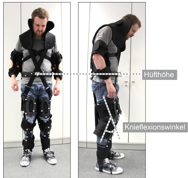
Abbildung 1: Der untersuchte Alterssimulationsanzug besteht aus mehreren Komponenten (Grafik A: Ellert & Mathee 2014), die mit individuell und stufenlos verstellbaren Gurten und Gummibändern verbunden werden. Die Fotos (B) zeigen einen Probanden beim Tragen des Anzuges für die Ganganalyse mit Markern. Die gepunkteten Linien weisen auf die im Ergebnisteil dargestellten Messgrößen hin.
