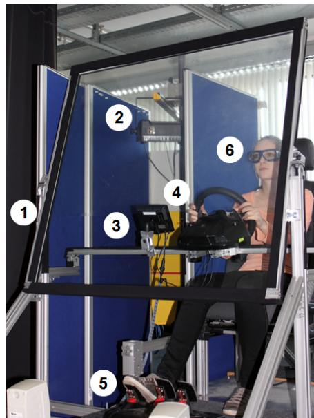
Abbildung 1: Versuchsaufbau mit Sitzkiste, Versuchskomponenten sowie Probandin mit Laserschutzbrille (6)
