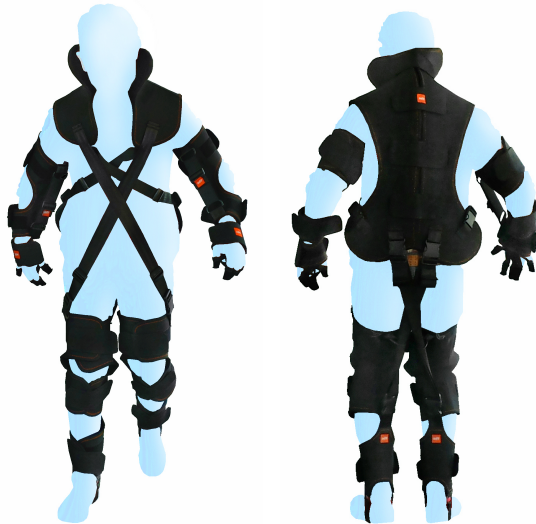
Abbildung 1: Der untersuchte Alterssimulationsanzug besteht aus mehreren Komponenten (Grafik A: Ellert & Mathee 2014), die mit individuell und stufenlos verstellbaren Gurten und Gummibändern verbunden werden. Die Fotos (B) zeigen einen Probanden beim Tragen des Anzuges für die Ganganalyse mit Markern. Die gepunkteten Linien weisen auf die im Ergebnisteil dargestellten Messgrößen hin.
