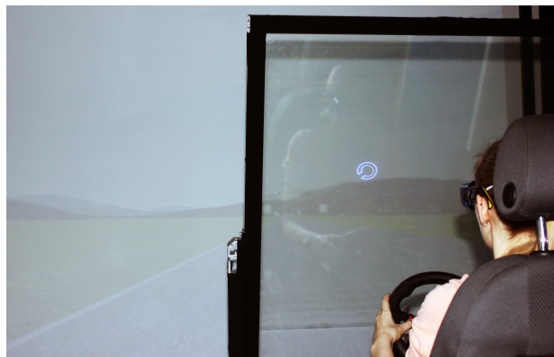
Abbildung 4: Probandin während einer Versuchsfahrt mit projizierten Landoltring an der Windschutzscheibe.
