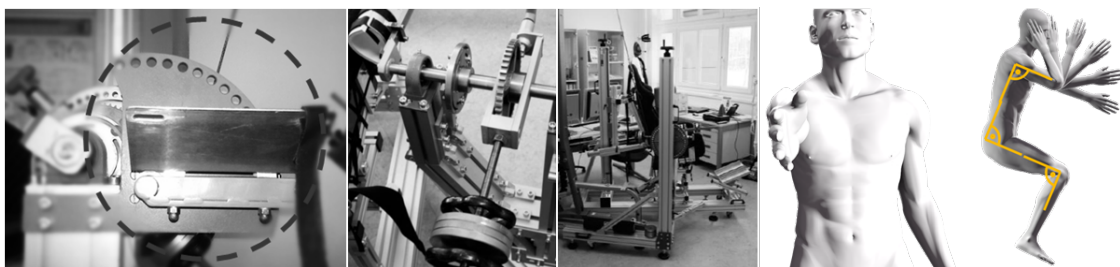
Abbildung 2: von links nach rechts: Oberarmstütze, Schwerkraftausgleich, Versuchsstand, neutrale Position des Unterarms, Körperhaltung des Probanden
