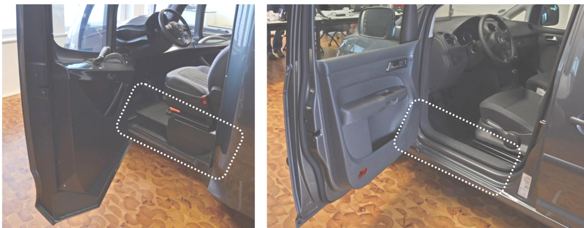
Abbildung 1: Ein-/Ausstiegsbereich des Standardfahrzeugs (rechts) sowie beim neuentwickelten Kabinenkonzept ohne Seitenschweller (links)
