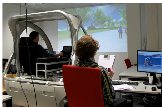
Abbildung 2: E2V-Mockup mit OpenDS-Fahrsimulation im Labor
